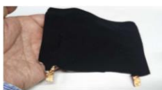
導電布を用いたテキスタイル・スピーカー 布上に印刷形成された温湿度センサーアレイ
